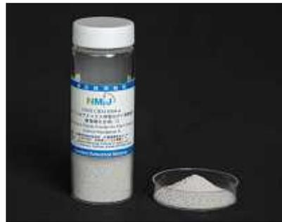
本標準物質は、ファインセラミックス用窒化けい素微粉末中の主成分および微量成分元素の定量において、分析の精度管理や分析方法・分析装置の妥当性確認に用いることができます。
